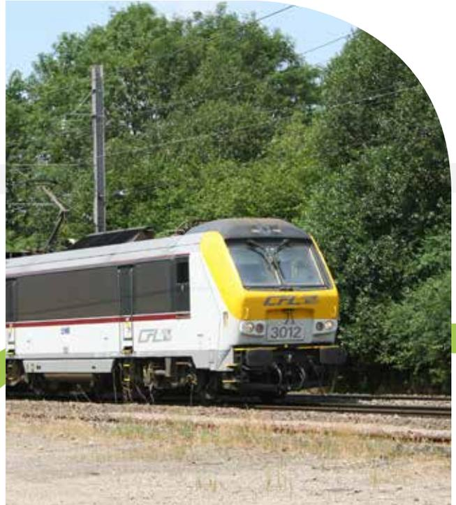
**20 locomotives électriques de ligne bitension 25 kV/50 Hz et 15 kV/16,7 Hz (Série 4000), dont 3 louées à CFL cargo**
